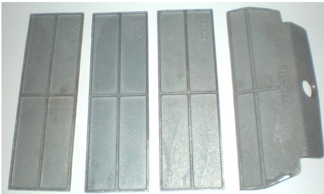
Фигура 1.4.4. Подредба на направляващите чугунени плочи, които формират ходовете на димните газове в горивната камера на котела.;
