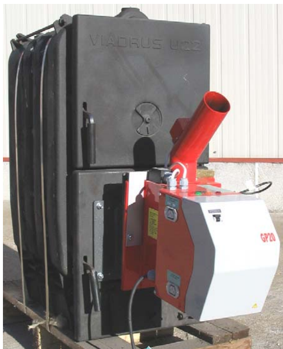
Фигура 1.4.7. Автоматизираната горелка за пелети от серията “GP” е монтирана на долната врата на водогрения котел “VIADRUS U22” (котелът е без монтирани външни капаци);
