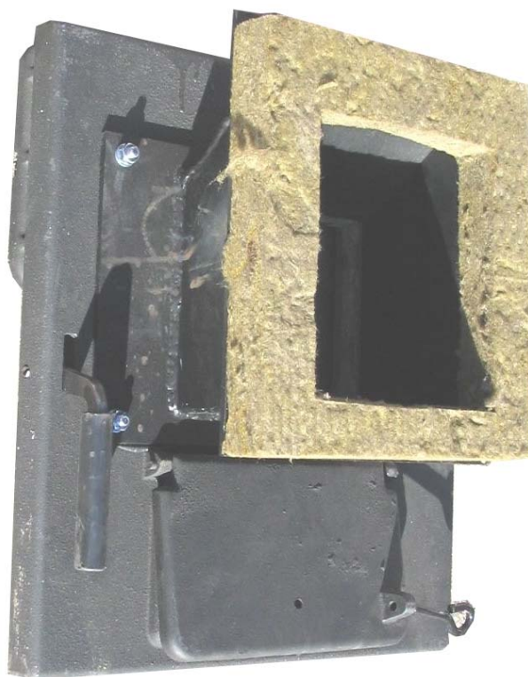
Фигура 1.4.3. Фланец (с поставена изолационна гарнитура между него и горелката) за закрепване на автоматизираната горелка за пелети от серията “GP”, монтиран на преработена долна врата на секционния чугунен водогреев котел “VIADRUS U22”;
